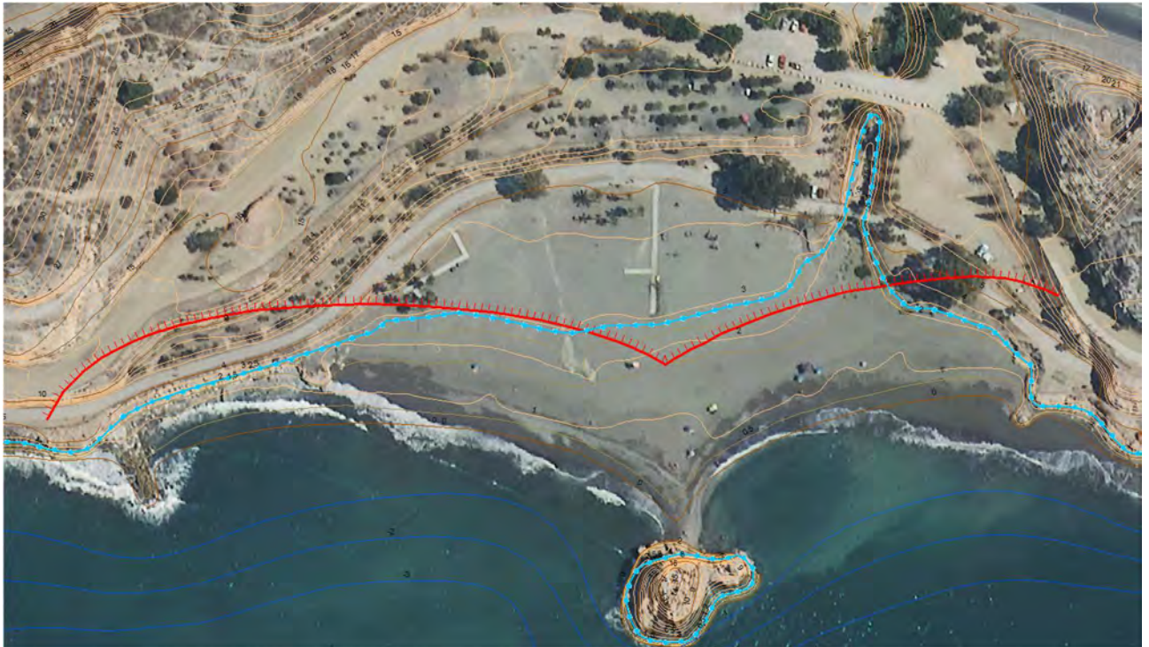
Representación gráfica de los alcances calculados mediante el C.E.M. (en rojo) y la cota de inundación mediante la fórmula de Nielsen-Hanslow (1991) corregida con los factores de Van der Meer y Jansen (en azul).
