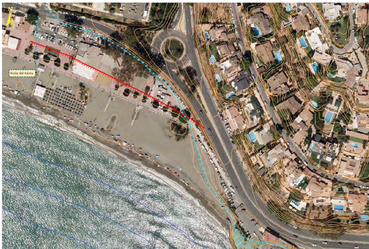
Representación gráfica de los alcances calculados mediante el C.E.M. (en rojo) y la cota de inundación mediante la fórmula de Nielsen-Hanslow (1991) corregida con los factores de Van der Meer y Jansen (en azul).
