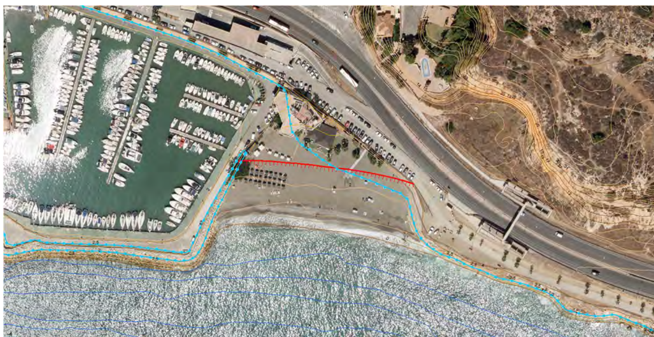
Representación gráfica de los alcances calculados mediante el C.E.M. (en rojo) y la cota de inundación mediante la fórmula de Nielsen-Hanslow (1991) corregida con los factores de Van der Meer y Jansen (en azul).
