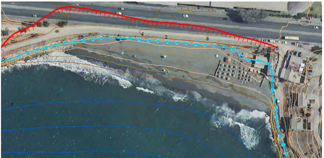
Representación gráfica de los alcances calculados mediante el C.E.M. (en rojo) y la cota de inundación mediante la fórmula de Nielsen-Hanslow (1991) corregida con los factores de Van der Meer y Jansen (en azul).
